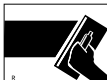
Realizar reparación del sustrato con materiales compatibles.
